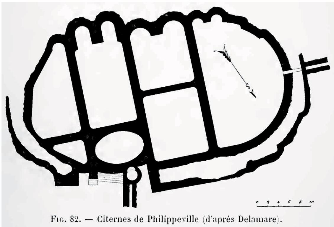
l'architecte y a multiplié les divisions et élargi les massifs de maçonnerie. Le grand rectangle qui vient d'être mentionné s'appuie sur un bassin de forme ovale,... flanqué lui-même d'un petit réservoir triangulaire. Enfin, il y a au sud-est un dernier bassin, dont le côté extérieur est arrondi, pour continuer la forme elliptique de l'ensemble...
